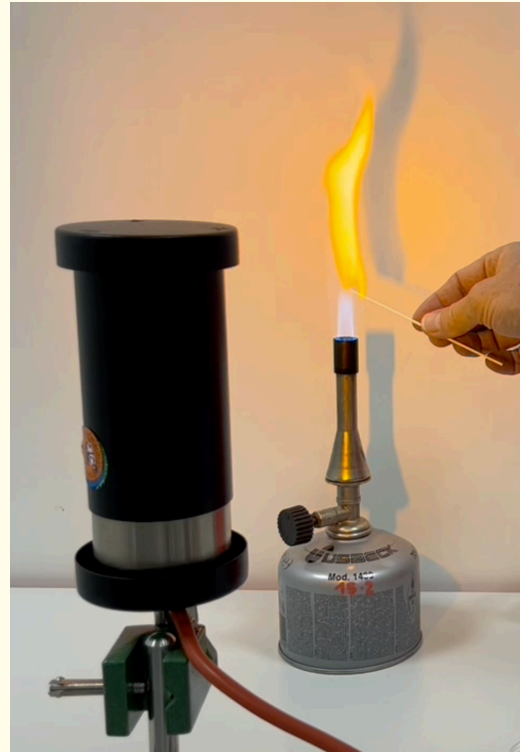
Na-Dampf Lampe mit NaCl in Brenner-Flamme
