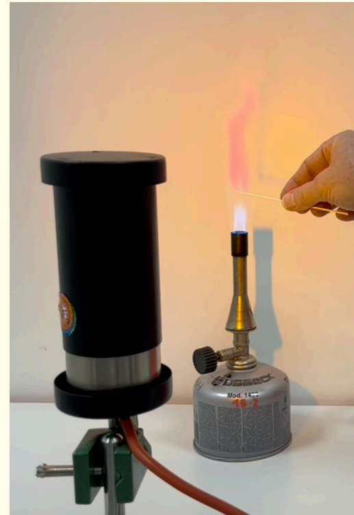
Na-Dampf Lampe mit LiCl in Brenner-Flamme
