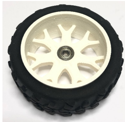
Abb. 3: Vordere Felge mit beidseitigen Kugellagern.
