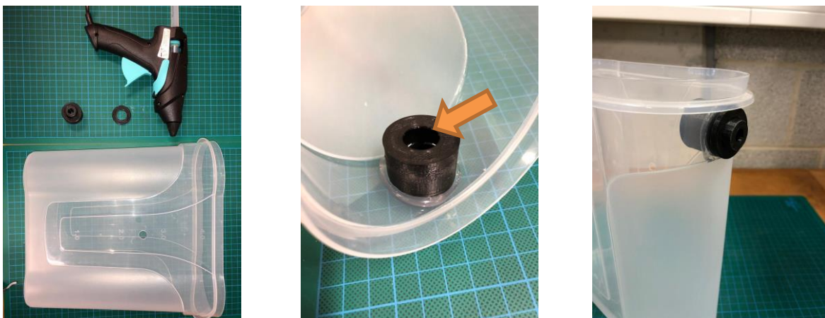
Abb. 08-10: Verkleben des Feeder-Gebers
