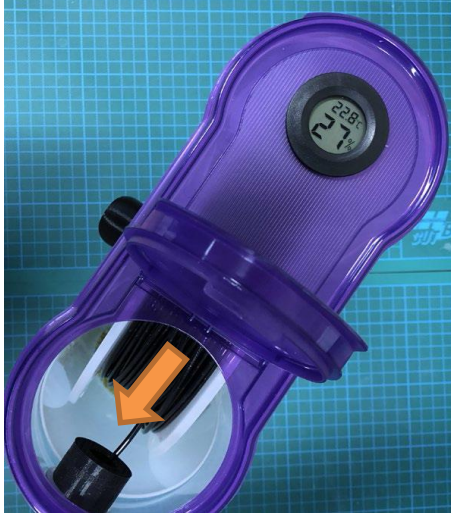
Abb. 20-21: PVA-Box mit Hydrometer und Temperaturanzeige
