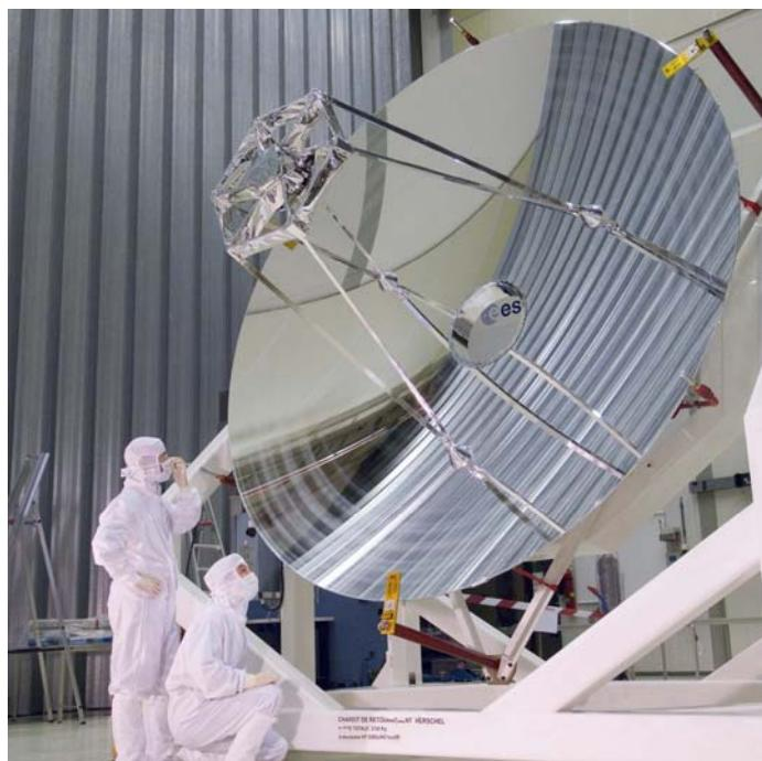
Der Teleskopspiegel des Weltraumobservatoriums Herschel auf dem Prüfstand. Die Spiegeloberfläche ist nicht völlig glatt. Ringförmige Spuren sind zu sehen. Stören diese Strukturen nicht bei der Beobachtung?
