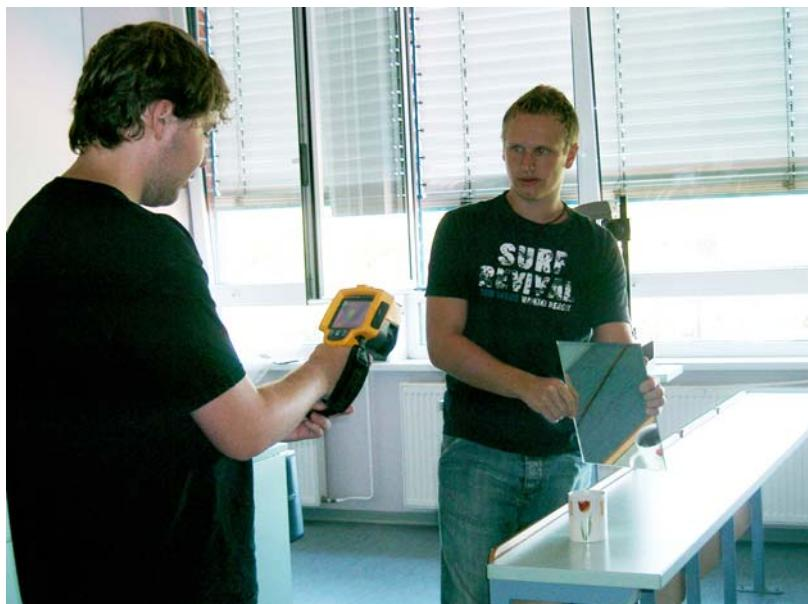
Die raue Metallplatte kann die MIR-Strahlung gut widerspiegeln, weil die MIR-Strahlung eine relative große Wellenlänge hat und von den Unebenheiten der Metallplatte nicht zerstreut wird (nur Licht mit kleineren Wellenlängen wird zerstreut, was erklärt, warum die Platte im Visuellen matt erscheint).
