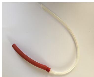
Teil D Elastischer Laborschlauch (10 cm, Durchmesser 10 mm) Elastischer Silikonschlauch (20 cm, Durchmesser 4 mm)
