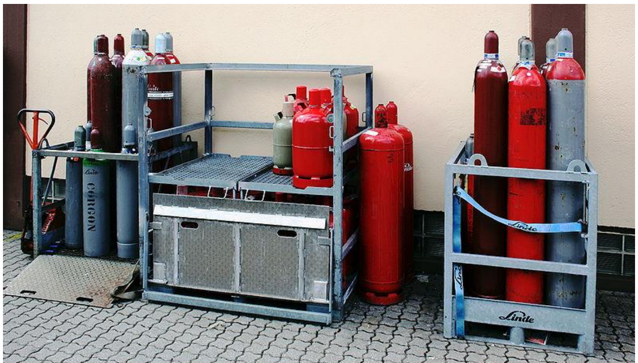
Verschiedene Druckgasflaschen. Die Farbenkombinationen (Flasche/Schulter) markieren verschieden Gase. grau/weiß steht z. B. für Sauerstoff, rot/rot für Wasserstoff.
