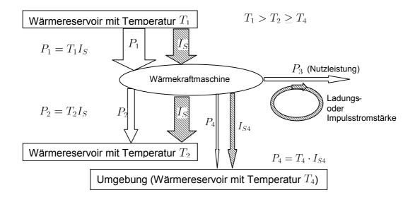
Da fließende Entropie immer Energie mit sich führt, wird auch Energie mit der Energiestromstärke  $P_4 = T_4 \cdot I_{S4}$  an die Umgebung abgegeben. Folglich bleibt nach dem Energieerhaltungssatz weniger Nutzleistung  $P_3$  bei der gleichen zugeführten Leistung  $P_1$  übrig. Damit wird der Wirkungsgrad geringer. Im Folgenden wird dieser Schluss noch ausführlicher begründet:
